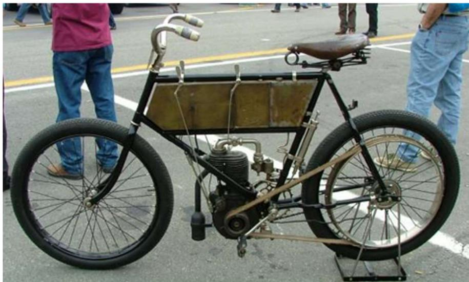
Un pédalier avec chaîne et pignon à roue libre permettait de la mettre en mouvement. À cet effet, on trouvait, sur la culasse du moteur, une soupape annexe commandée par une gâchette disposée sur le guidon.
